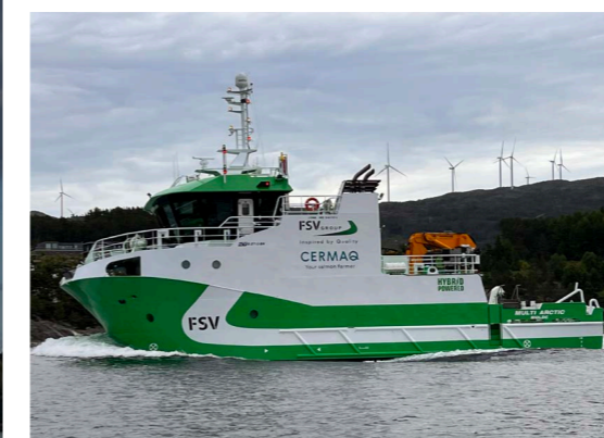
FMV52 «Multi Artic» levert 2023 fra FMV. Fartøyet har en batteripakke på 1000 kWh om bord. FSV har beregnet at de vil spare 340 tonn CO2-utslipp årlig. Enova ga støtte og gjorde dette økonomisk mulig for rederiet.
