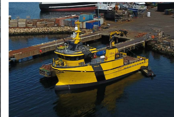
FMV218 «Niklas». Levert fra FMV i 2016. Fartøyet er solid bygd og har fremdeles framtiden foran seg. Våren 2024 installerte vi batteripakke på 1450 kWh om bord. Enova ga støtte og gjorde dette økonomisk mulig for rederiet.
